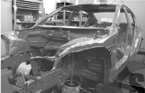
図1. ホワイトボディの多点加振実験
