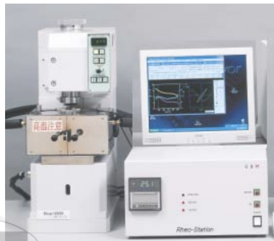
図1 動的粘弾性測定装置 Rheogel-E4000
