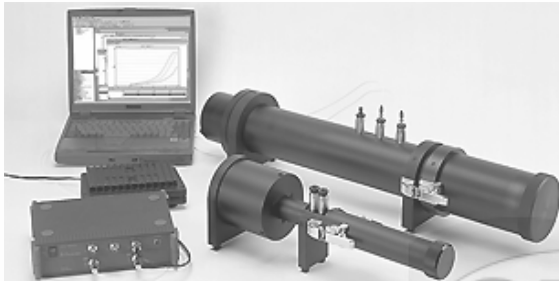
写真1. 2マイクロホン法垂直入射吸音率測定システム
