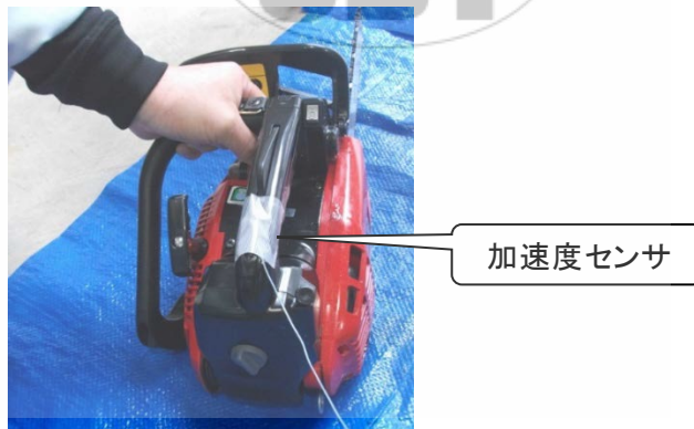
図 1 加速度センサ取り付け位置 (G2551T)
